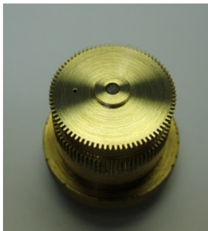
Tournage et taillage de la roue de barillet
