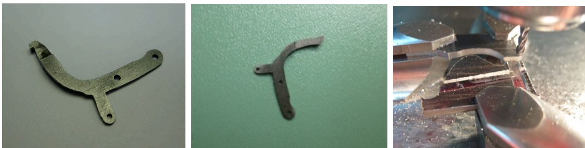
Deux modèles de tout-ou-rien différents et réalisation des épaulements
