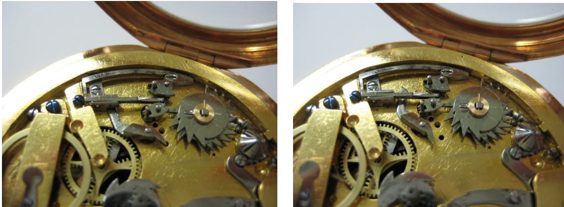
Levées débrayées (sonnerie au repos) et levées descendues (sonnerie active)
