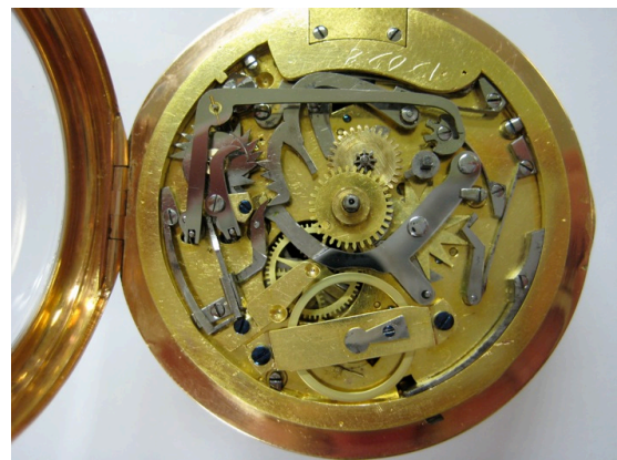
Cadrature avant et après restauration
