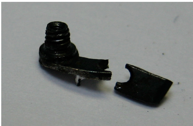
Support des cloches cassé et support des cloches refait
