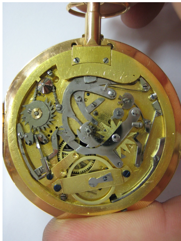
Sonnerie au repos et sonnerie en cours d'armage (le tout-ou-rien n'a pas encore agi sur l'isolateur, les levées sont encore débrayées)
