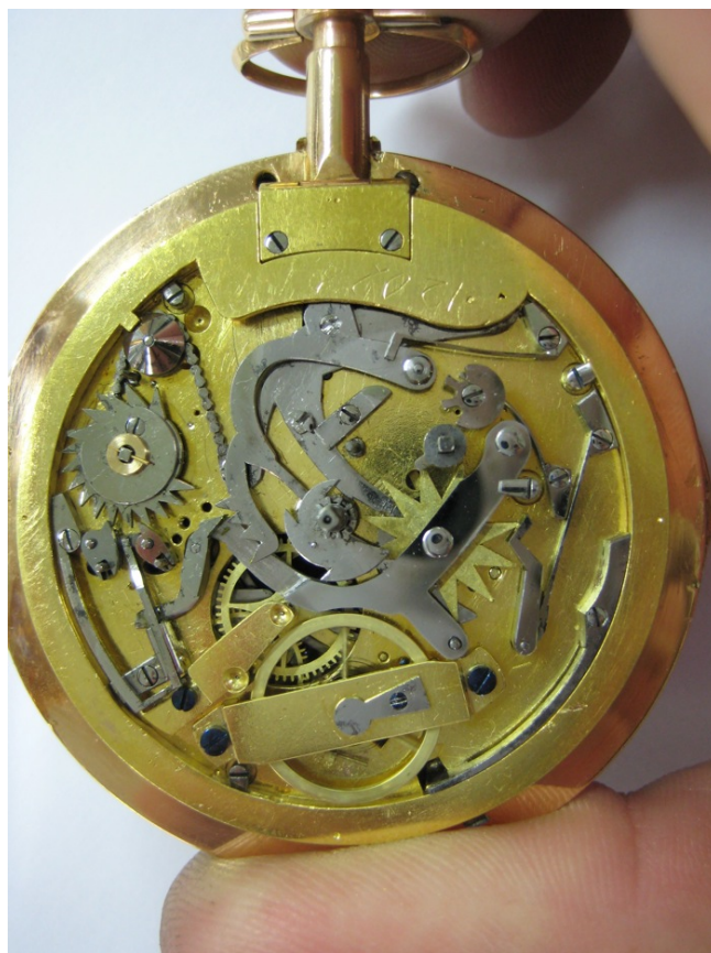
Le tout-ou-rien fait sa fonction sous la pression de la crémaillère, l'isolateur vient se loger entre deux dents de la pièce aux quarts et débraille les levées via le levier de débrayage.
