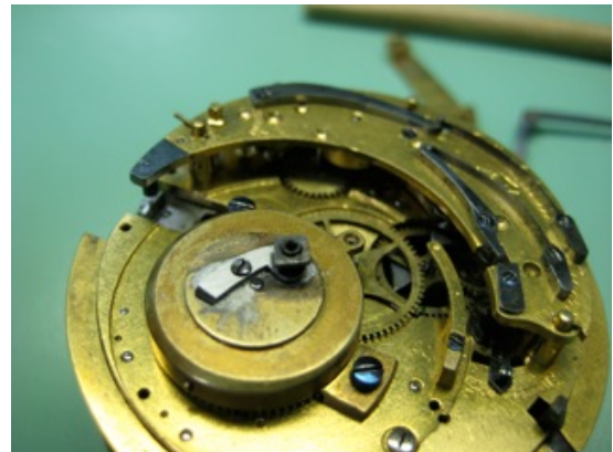
Support des cloches cassé et support des cloches refait
