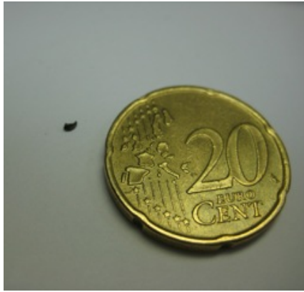
Cliquet et son ressort en cours de fabrication
