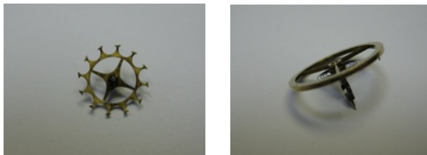
Mobile d'échappement et balancier-spiral à cylindre
