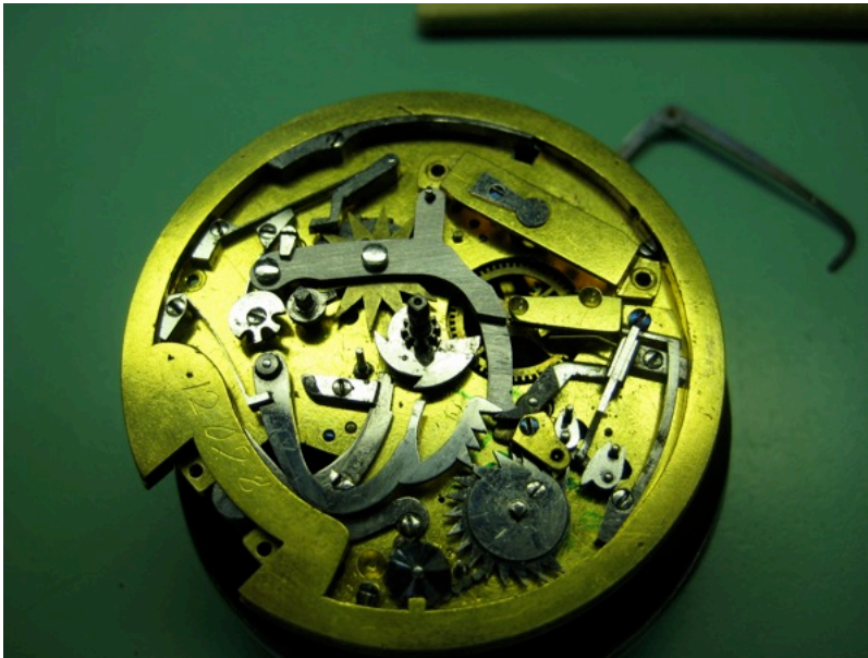
Test du tout-ou-rien et axe de rotation
