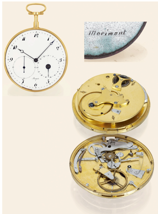
Répétition cinq minutes de type Stogden/Bréguet, calendrier révolutionnaire, Bréguet, 1792.
