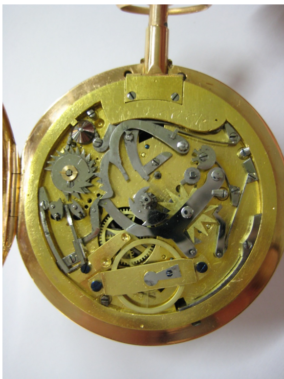
Sonnerie au repos et sonnerie en cours d'armage (le tout-ou-rien n'a pas encore agi sur l'isolateur, les levées sont encore débrayées)
