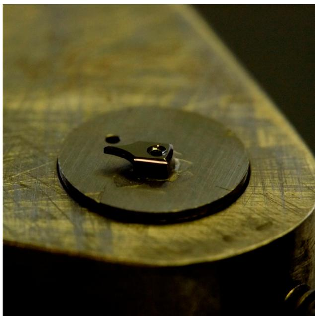
*Partie supérieure également polie sur bloc de zinc avec le tripode. Goutte préalablement polie à la sphère de bois et diamantine.*
