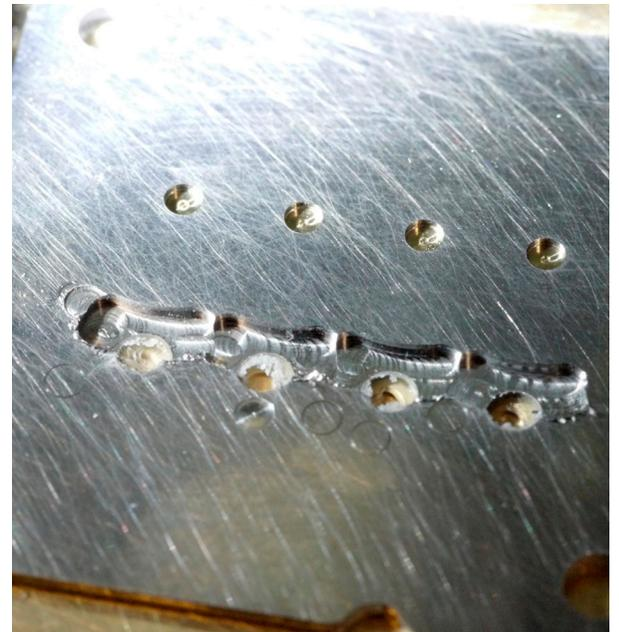
*Fraisage et ébauche d'angle à l'aide d'un outil à 90° pour le talon du pont.*
