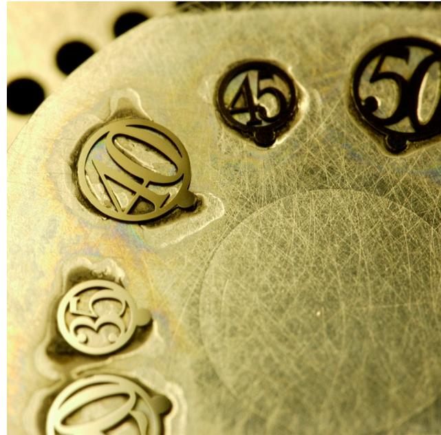
*Polissage bloqué de la série complète sur bloc de zinc et pâte diamantée.*
