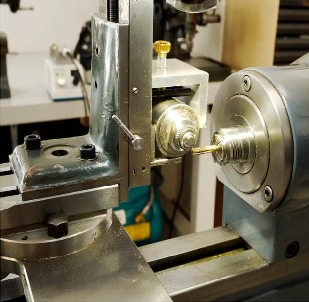
*Juillet 2014. Les taillages sont réalisés sur le tour Schaublin 70. Broche Gepy à la place de l'appareil à fraiser classique.*
