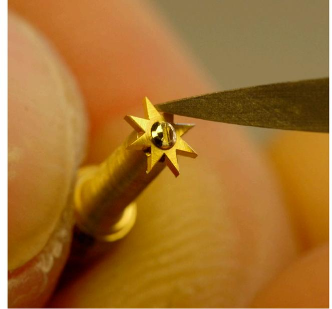
*Anglages des roues étoiles à la lime puis à l'abrasif fin. Polissage final au bois chargé de diamantine.*
