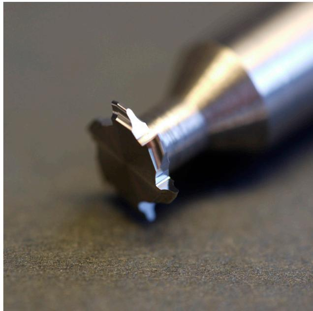
*Fraise de taillage module 0,2129 réalisée spécialement pour le projet par Complexcoup à Damprichard.*
