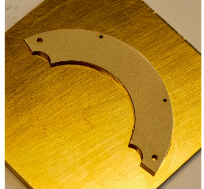
*Fraisage des contours des deux cadrans en laiton. Ebauche des angles à la fraise à 90°.*
