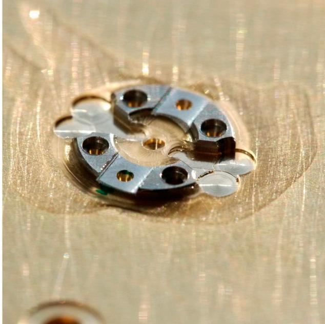
*Janvier 2015. Usinage du pont de déclenchement en deux parties. Ici la partie inférieure.*
