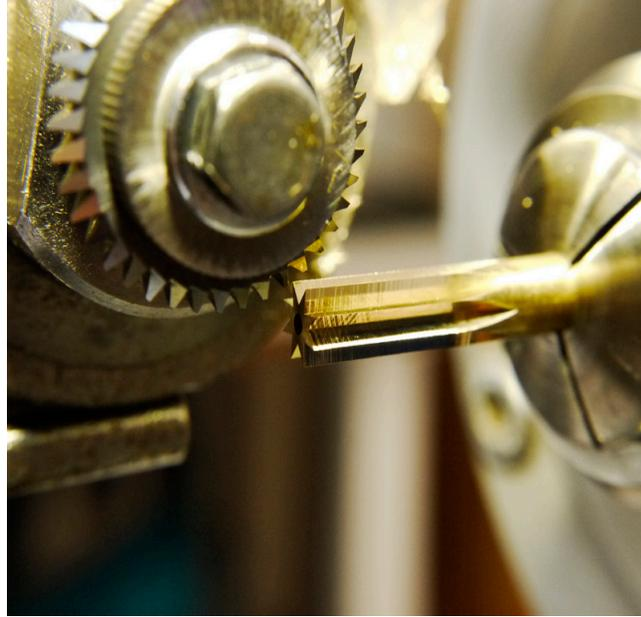
*Taillage des roues étoiles sur le même embout de laiton. Celles-ci seront tronçonnées en place.*
