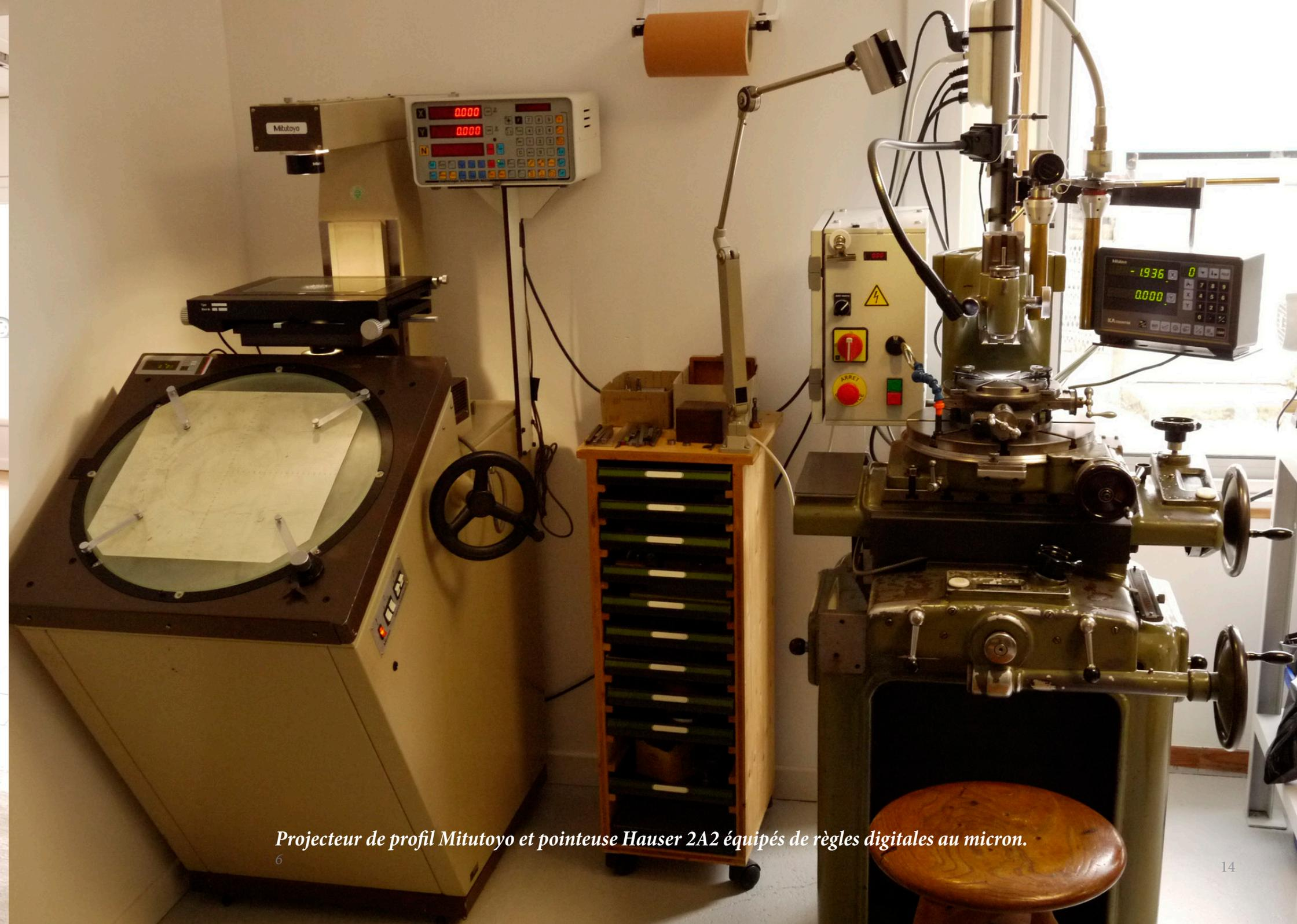
*Projecteur de profil Mitutoyo et pointeuse Hauser 2A2 équipés de règles digitales au micron.*
