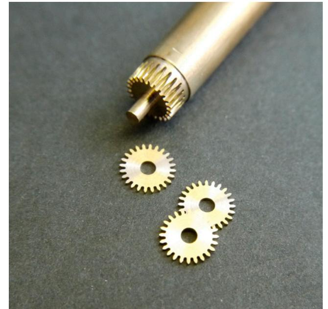
*Les rondelles préalablement cerclées sont comprimées sur un posage. Aucune bavure n'est visible lors du démontage des roues.*
