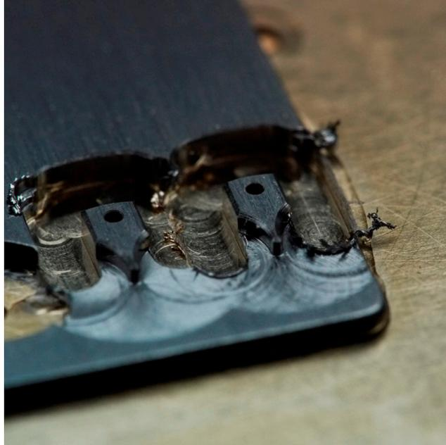
*Usinage de la partie supérieure. L'ébauche de l'anglage est réalisé également sur la machine à pointer pour cette pièce.*
