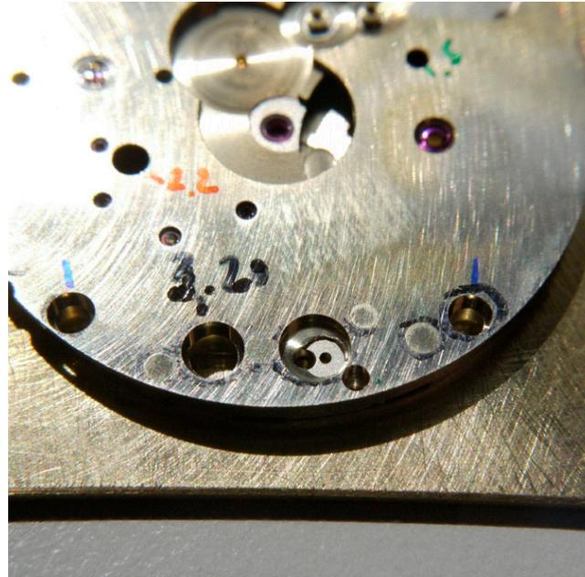
Fabrication d'un total de 22 bouchons pour la platine et empierrage du barrillet.
