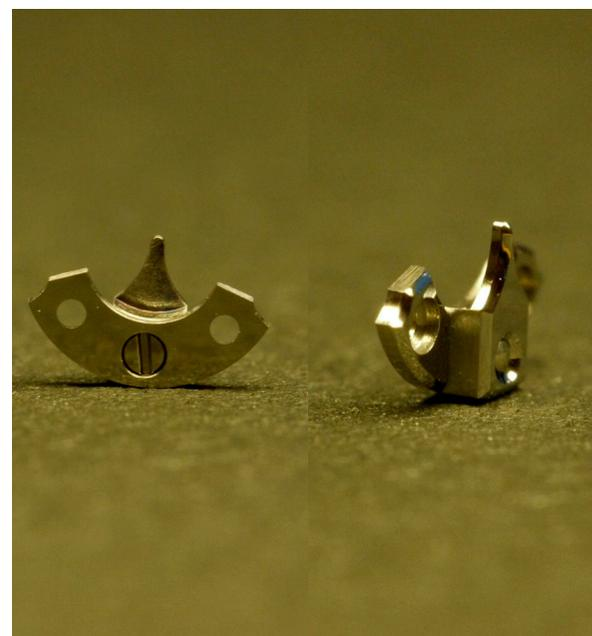
*Pont de déclenchement monté et terminé sur toutes les surfaces.*
