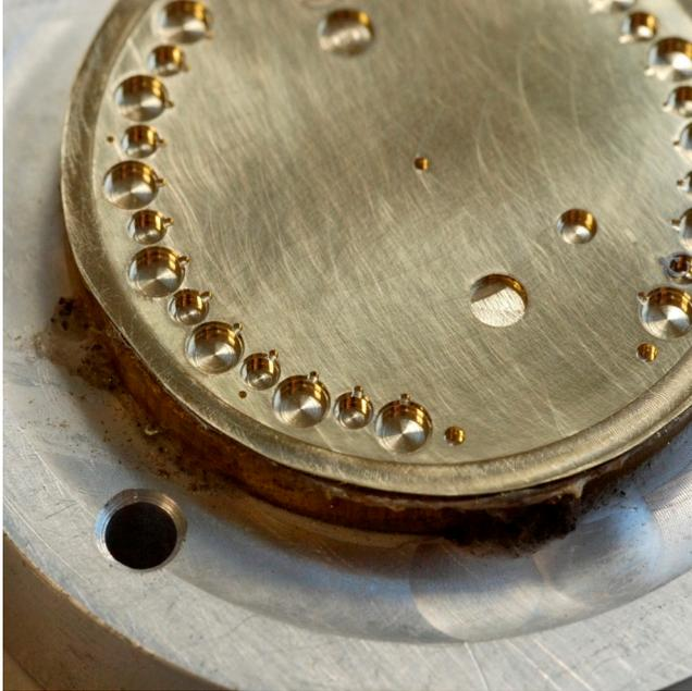
*Novembre 2014. Fabrication du cadran des minutes en laiton. Usinage du logement des appliques orientées sur le dessous.*
